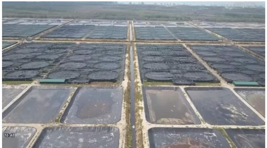
**Serie de estanques reservorios, revestidos, para cada módulo de tanque redondo**
